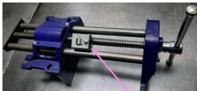
obr.2 Pohled správné polohy matice \ pic.2 View of the correct position of the nut \ Abb.2 Ansicht auf die korrekte Position der Mutter Ansicht auf die korrekte Position der
